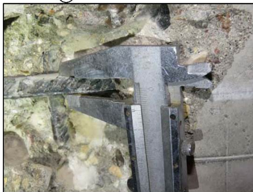
ФОТО 2. Уточнение диаметра рабочей арматуры потолочной поверхности железобетонной плиты перекрытия подвала по оси «И/4» между осями «2/4» и «3/4».
