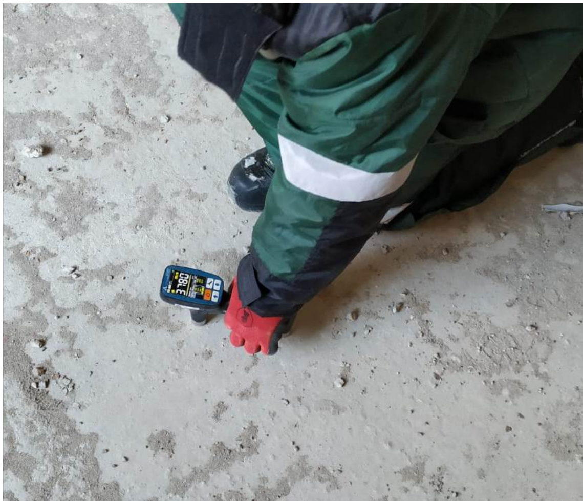
Рис. 4.3.1. Определение прочности бетона в монолитной плите перекрытия 1-го этажа ультразвуковым методом прибором UK 1401
