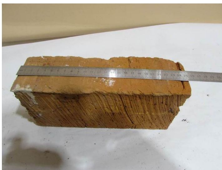
Рис. 3.7.2. Определение геометрических размеров кирпичных образцов
