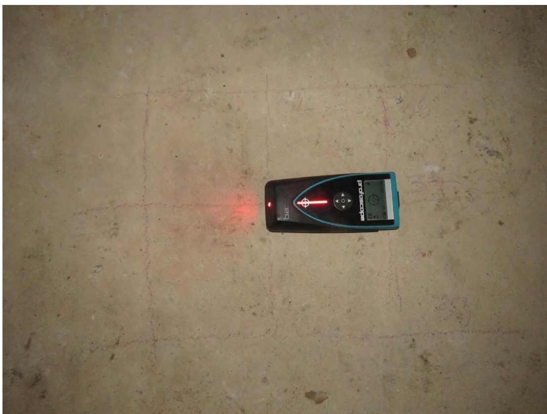
Рис. 3.3.4. Определение положения рабочей арматуры и толщины защитного слоя бетона в монолитной ж.б. плите перекрытия магнитным методом прибором «Profoscope»
