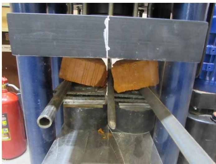
Рис. 3.7.3. Общий вид образцов после проведения испытаний по определению предела прочности при изгибе
