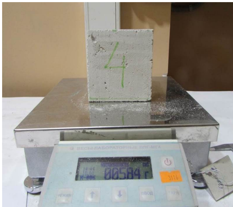
Рис. 3.6.2. Общий вид контрольных образцов-кубов, выпиленных из центральной части блока из ячеистого бетона
