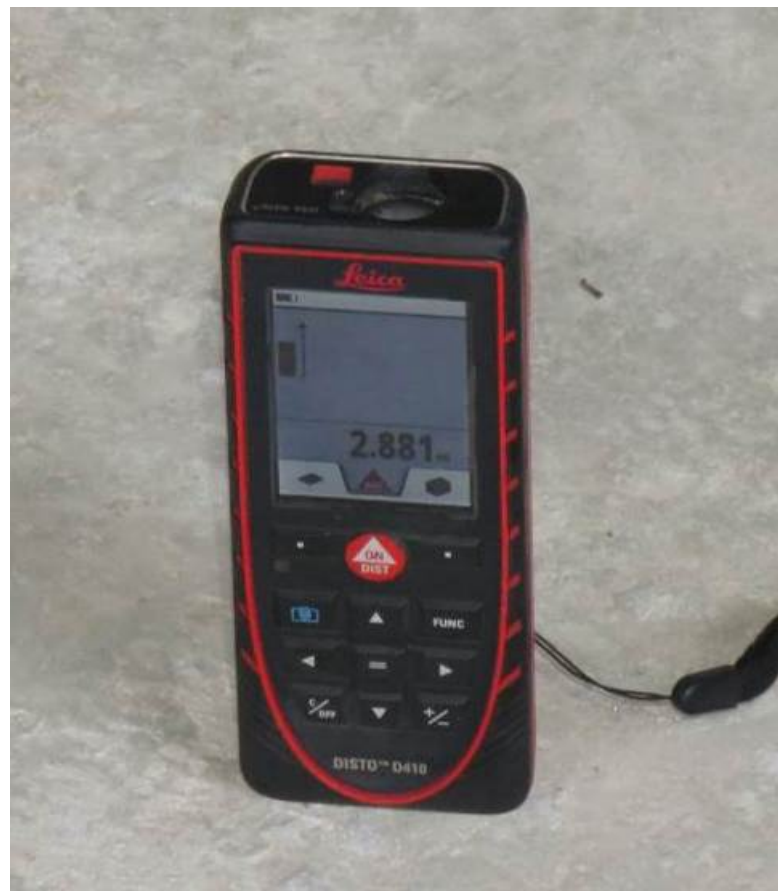
Рис. 2.4. Замер высоты помещений типового этажа секции №3 при помощи лазерного дальномера Leica DISTO D410
