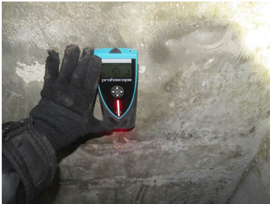
Рис. 3.5.7. Уточнение величин защитного слоя бетона монолитных лестничных конструкций
